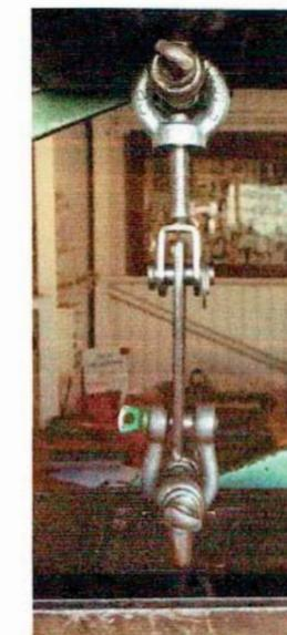
Bild 1: Befestigungssystem beim ersten Versuch
